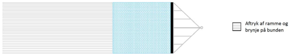
Figur 6. Konceptuelt redskabs-fodafttryk for en muslingeskraber, der viser slæbesporet for arealpåvirkning for den samlede påvirkning af havbunden fra ramme og brynje (figur fra Eigaard et al 2016).
